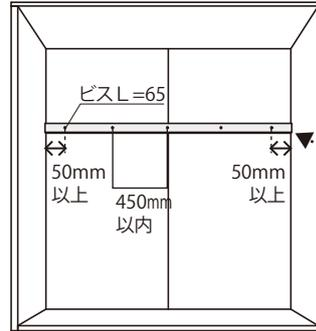
後受棧を間口寸法にカットし、前框位置を確認の上、後壁面にワッシャーを通したビスで止め、ビスキャップを取り付けてください。
