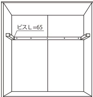
左右の側受棧を両側壁面にワッシャーを通したビスで止め、ビスキャップを取り付けてください。
