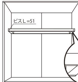
前受棧を間口寸法にカットし、左右側受棧木口中央部にビス止めしてください。
